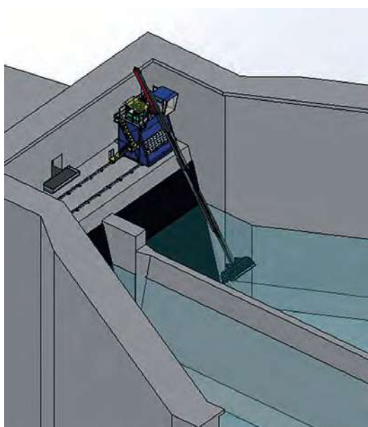
Conveyance Tank मा राखिने अतिरिक्त TRCM को Design
