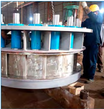
Turbine पार्टपूजाको निरिक्षण कार्य
